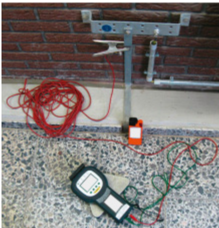
Abbildung 5: Dreipunkt-Elektrode und Messgerät
